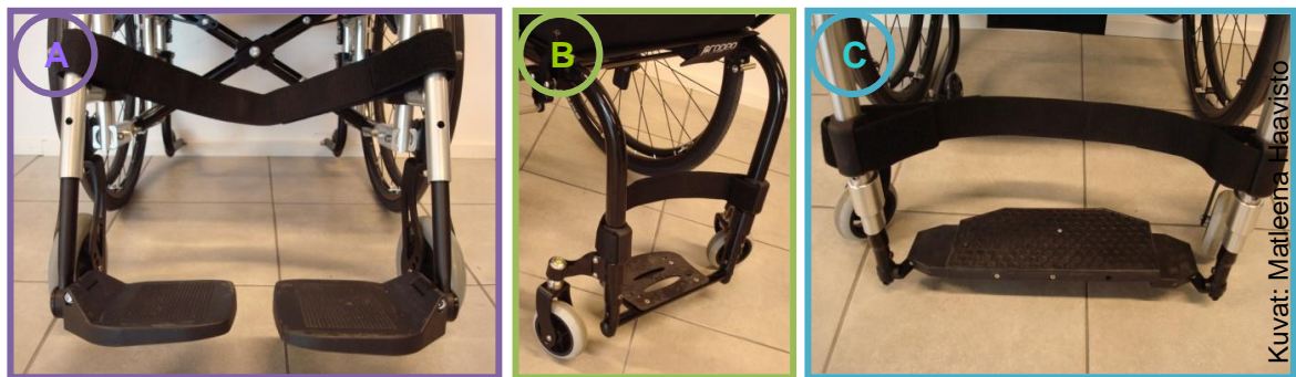
KUVA 14. Erilaisia jalkalautoja. A) kaksiosainen jalkalauta, B) kiinteä jalkalauta ja C) jalkatuen viereen kääntyvä jalkalauta
