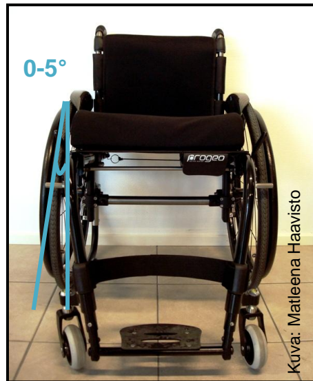
KUVA 19. Camber-kulma on yleensä 0-5°.
