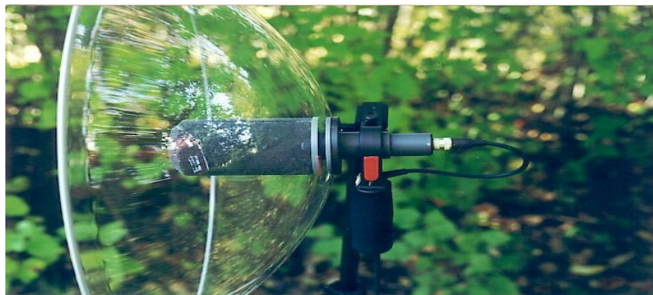
Kuva 4: Parabolinen heijastin (Telinga.thestrandbergs 2009)
