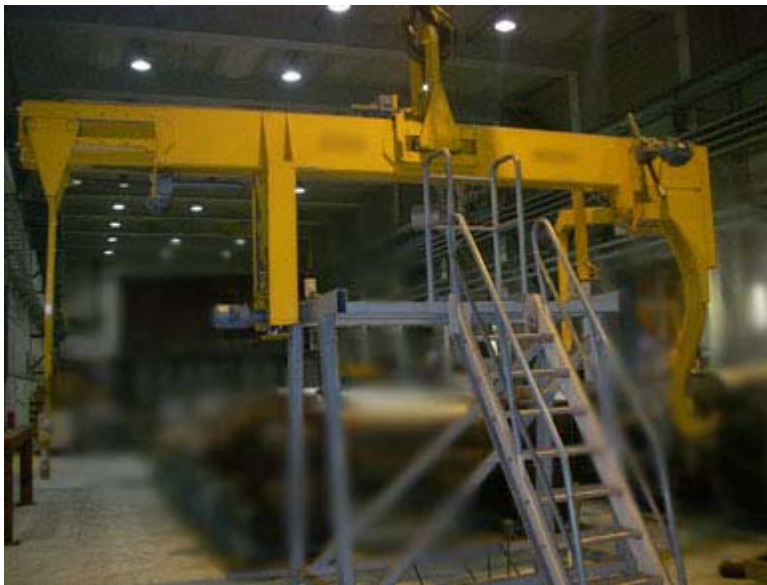
Kuva 11. 2Hi-nostoapulaite säilytystason päällä ja kiinnitettynä siltanosturiin
