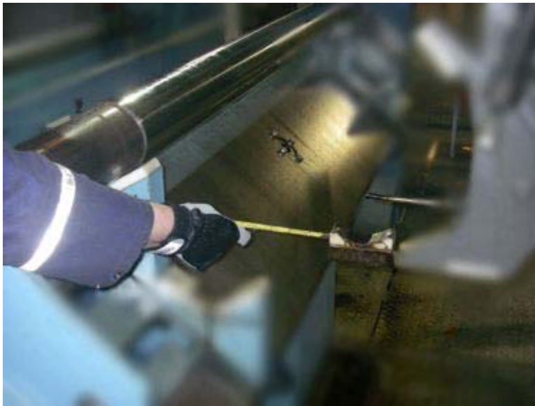
Kuva 18. WRR-robotin aseman selvittäminen mittaamalla
