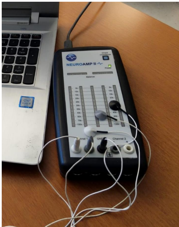
KUVA 2. Neuroamp-laite, jonka kautta potilaan sähköisen aivotoiminnan tiedot siirtyvät tietokoneelle (Kuvaaja Julia Kronqvist)
