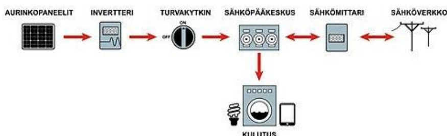
KUVA 7 Verkkoonliitetyn aurinkosähköjärjestelmän rakenne (Motiva Oy, 2016)
