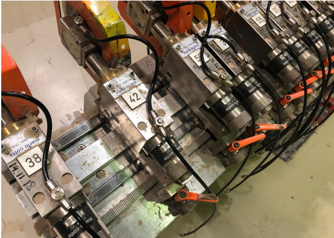
Kuva 2. Uuden pituusleikkurin vaunun liukukisko ja terät. Kuvassa varaterät rivissä.
