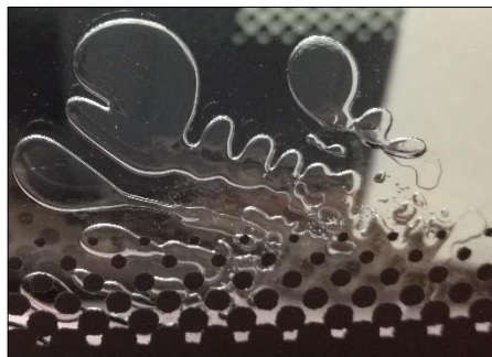
Kuva 10. Kosteudesta johtuva kupla.
