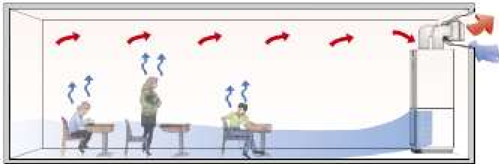
Kuva 16: Syrjäyttävän ilmapaihtolaitteen toimintaperiaate. (Kuva Swegon Oy)
