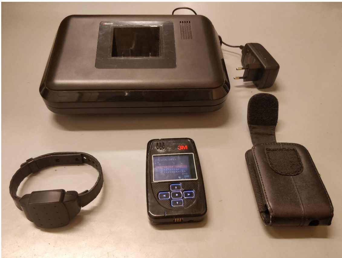
Kuva 1: 2TRACK-laitteisto (ylhällä: kotitelakka, alarivissä vasemmalta: panta, seurantapuhelin, puhelimen kotelo)
