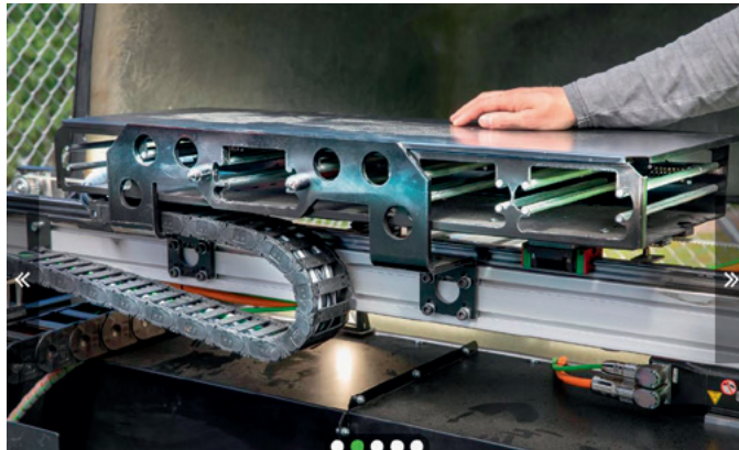
Kuva 8. Telakointiaseman "revolveriin" eli akkukasettiin mahtuu kuusi akkua. (Maaseudun tulevaisuus, 2018. Kuvaaja Marja Seppälä)
