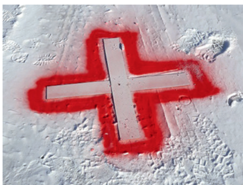
Kuva 13. Kemin Energian kohteessa käytetty signaali, jonka keskipiste mitattiin GNSS-vastaanottimella.
