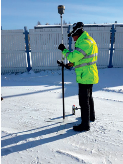
Kuva 1. Mitta Oy:n Raimo Höynälä mittaamassa signaalin koordinaatteja sauvan päähän kiinnitetyllä GNSS-vastaanottimella.
