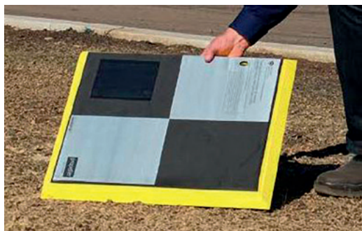
Kuva 3. Propeller AeroPoints itsepaikoittuva älysignaali. (Mäenpää)
