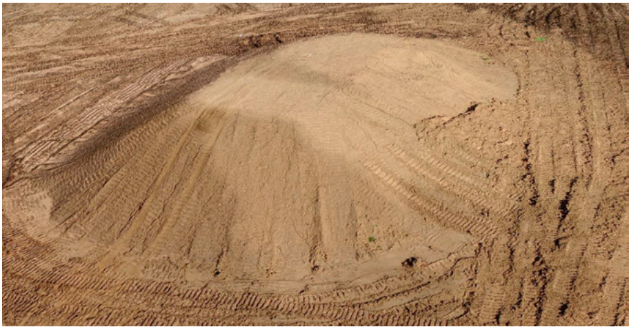
Kuva 2. Teksturoitu tiheä pistepilvi hiekkakasasta. (Datamate, 2017)
