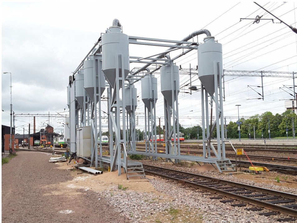
Kuva 13. Hiekanantolaitteet löytyvät isoimmilta vetokalustovarikoilta. Muilla paikoilla – tai tarvittaessa vaikka kesken matkan – hiekka annostellaan pienistä säkeistä veturin hiekkasäiliöihin.
