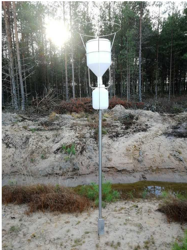
Kuva 6 Laskeumakeryksessä käytetty NILU:n keräin
