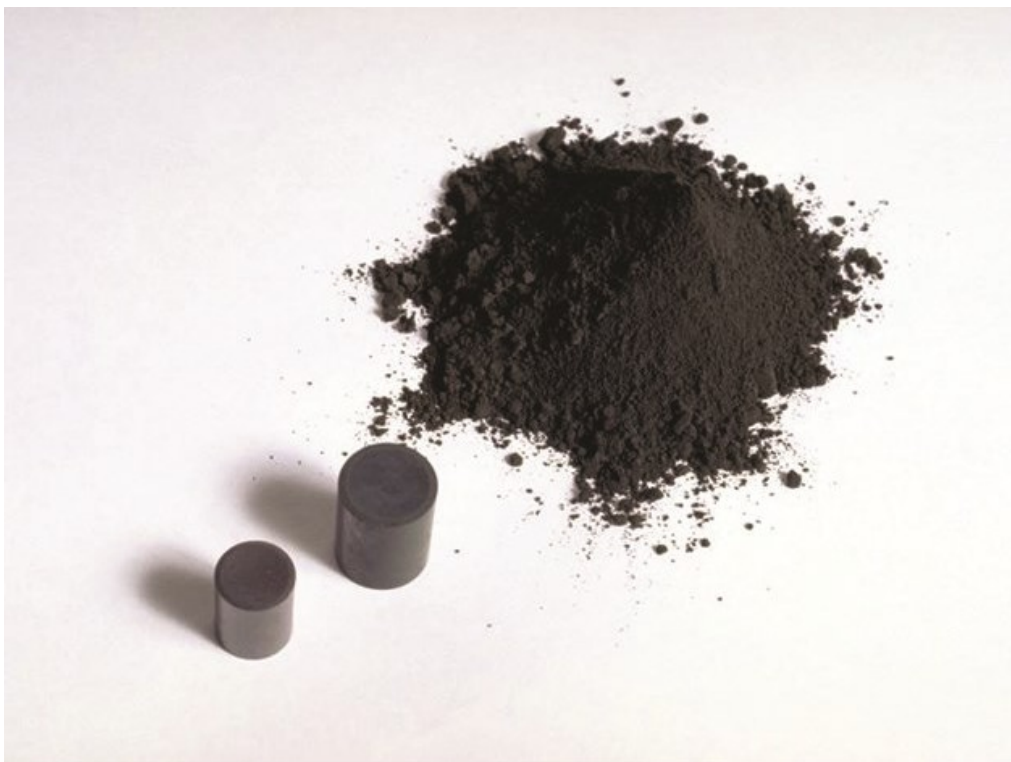
KUVA 1. CANDU-reaktorin uraanioksidia jauheena ja pelletteinä (WNA. 6.2019.)
