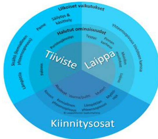
KUVA 5. Laippaliitokseen vaikuttavat muuttujat (Marko Vattulainen, 2018)
