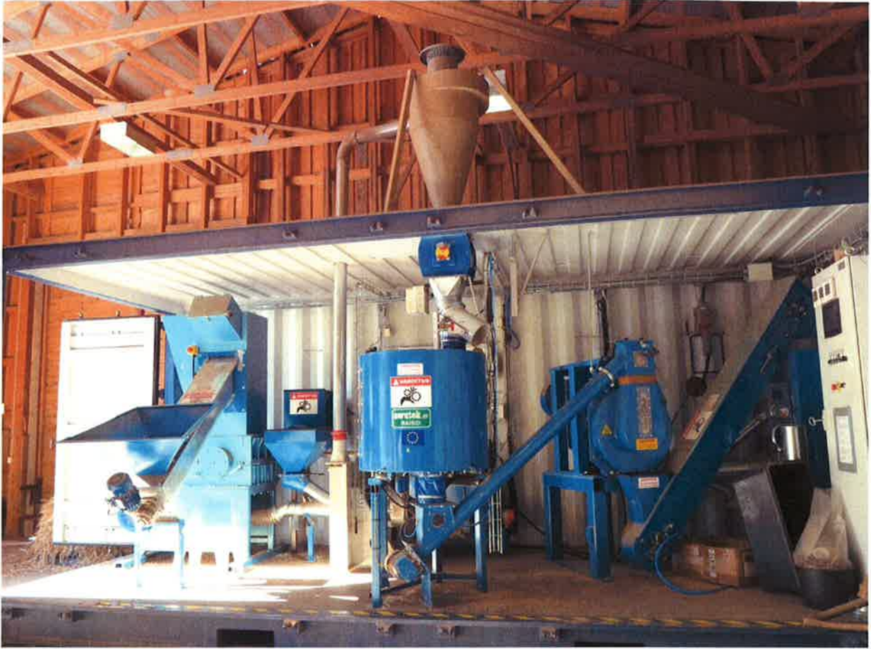
Kuva 1. Oamk:n Luonnonvara-alan yksikön liikuteltava, pilot-mittakaavan pelletöintilaitteisto.
