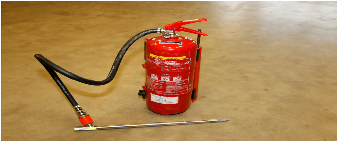
Kuva 17. Jauhesammutin hyökkävällä pistosuihkuputkella. RPS 101 kalustoa.
