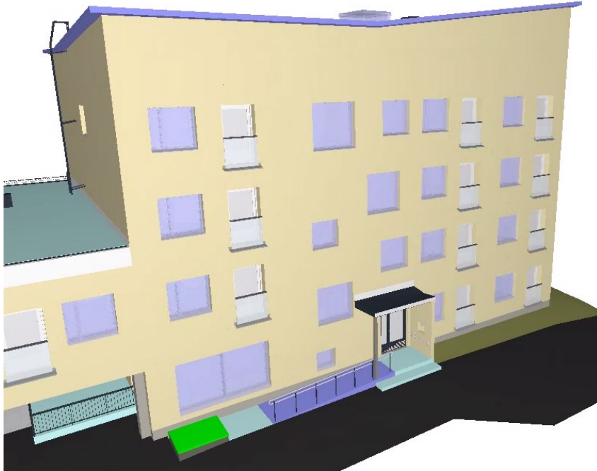
Kuva 34. Kuvakaappaus tietomallista kolmannesta työkohteesta. Vihreällä korostettu savunpoistoluukun kansi (25.1.2019).
