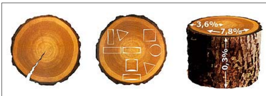
Kuva 6. Puun pitkittäis-suuntainen kosteuseläminen on vähäistä, mutta poikkisuuntainen kosteuseläminen voi olla voimakasta. Se on huomioitava rakenteita ja yksityiskohtia suunniteltaessa [29].
