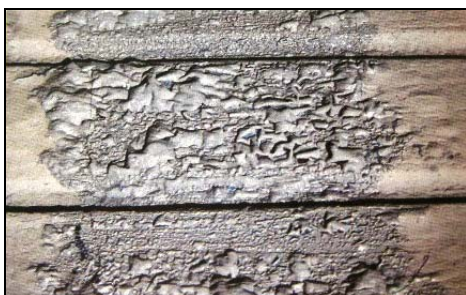
Kuva 12. Metyyleenikloridia sisältävät maalinpoistoaineet pehmittävät maalikalvon nopeasti [24, s. 22].
