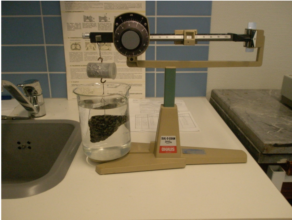
Kuva 6 Kiviäytteen kiintotiheyden mittaus tarkkuusvaa'alla
