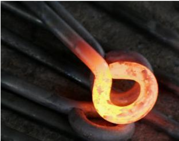
Fig.9 Le fer émet de la lumière visible à partir d'une certaine température.
