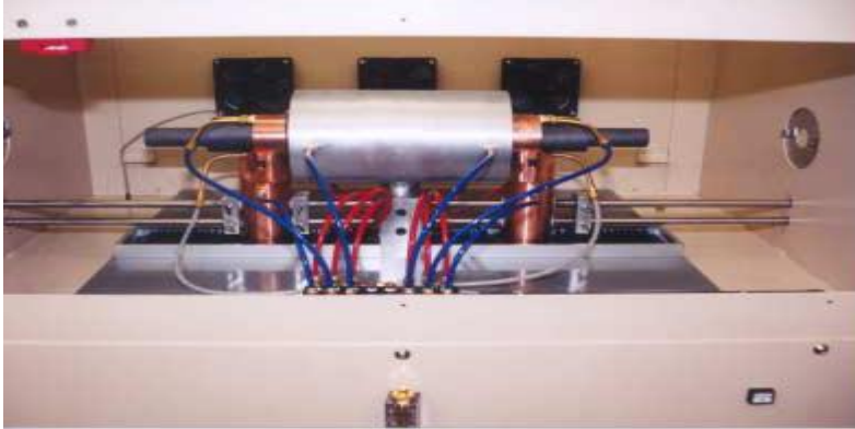
Figure 19 Double cavités d'un corps noir
