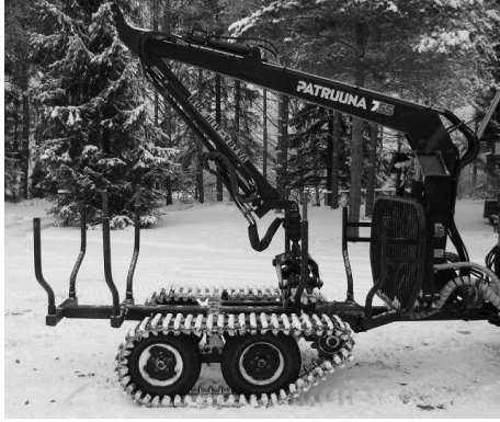
KUVA 34. Nosturin suunniteltu asento levittimen kanssa
