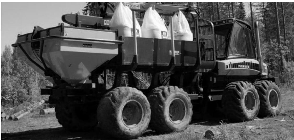
KUVA 7. Ponsse-metsäkoneisiin asennettava apulannanlevitin (5)
