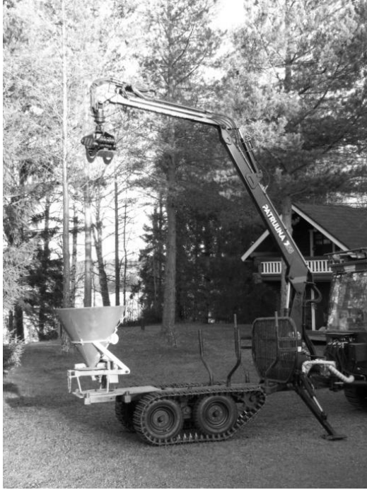
KUVA 33. Lannoitteen täytön simulointia
