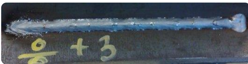
Kuva 21. Vasemman puolen langansyöttönopeus oli 18,7 m/min.
