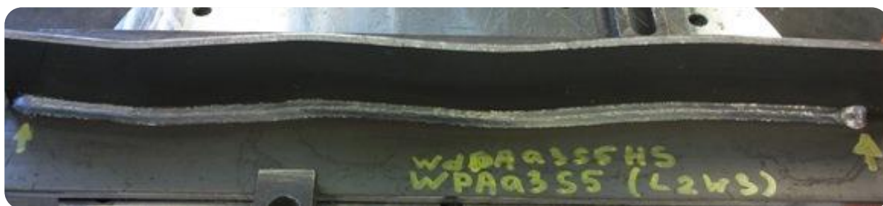
Kuva 14. Weavedatan avulla hitsattava liitos.
