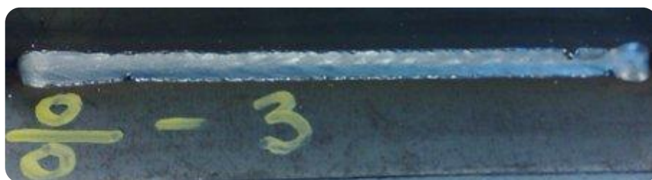
Kuva 22. Oikean puolen langansyöttönopeus oli 15,7 m/min.
