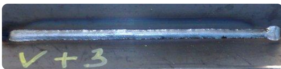
Kuva 18. Oikean puolen hitsausnopeus oli 14,25 mm/s.
