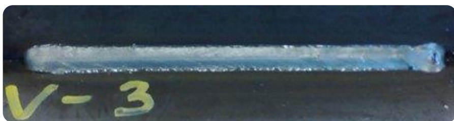
Kuva 19. Vasemman puolen hitsausnopeus oli 8,25 mm/s.
