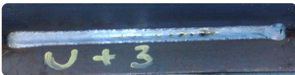
Kuva 24. Vasemman puolen kaarijännite oli 26,5 V.
