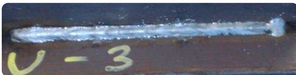
Kuva 25. Oikean puolen kaarijännite oli 20,5 V.
