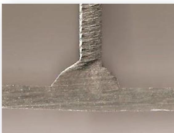
Kuva 17. Vasemman puolen hitsausnopeus oli 8,25 mm/s.
