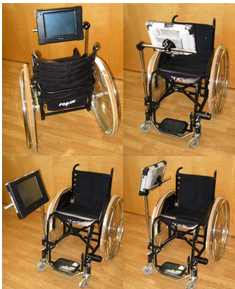
Kuva 3. Comp-Aid Oy:n DaeSSy –pyörätuolikiinnitysjärjestelmä ja AMDi Tech Touch-laite. (Comp-Aid Oy, 2007.)
