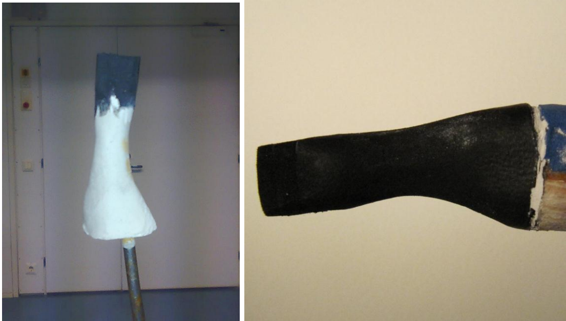
KUVIO 20. Pehmusteen paksuisella solumuovilla päällystetty kipsi.
