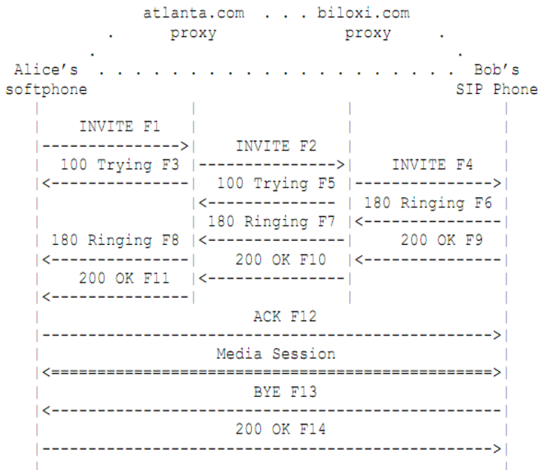
Kuva 6. SIP-puolisuunnikkaan muotoinen yhteys kahden välityspalvelimen kautta.[2]
