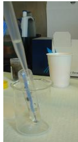
KUVIO 2: Uuttoliuoksen lisäys näyteputkeen (Hakuli 2010).
