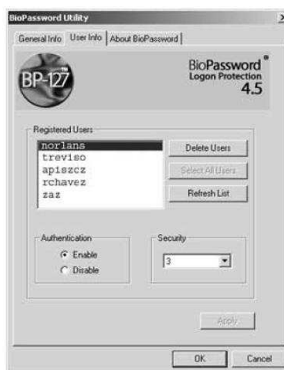
Kuva 20. BioPassword-ohjelmiston konfigurointivalikko. Valikossa voi mm. poistaa käyttäjätilejä ja muokata tunnistustarkkuuden tasoa. Suurempi tarkkuus lisää epäonnistuneiden kirjautumisten määrää, mutta vähentää väärin hyväksytyjen määrää.
