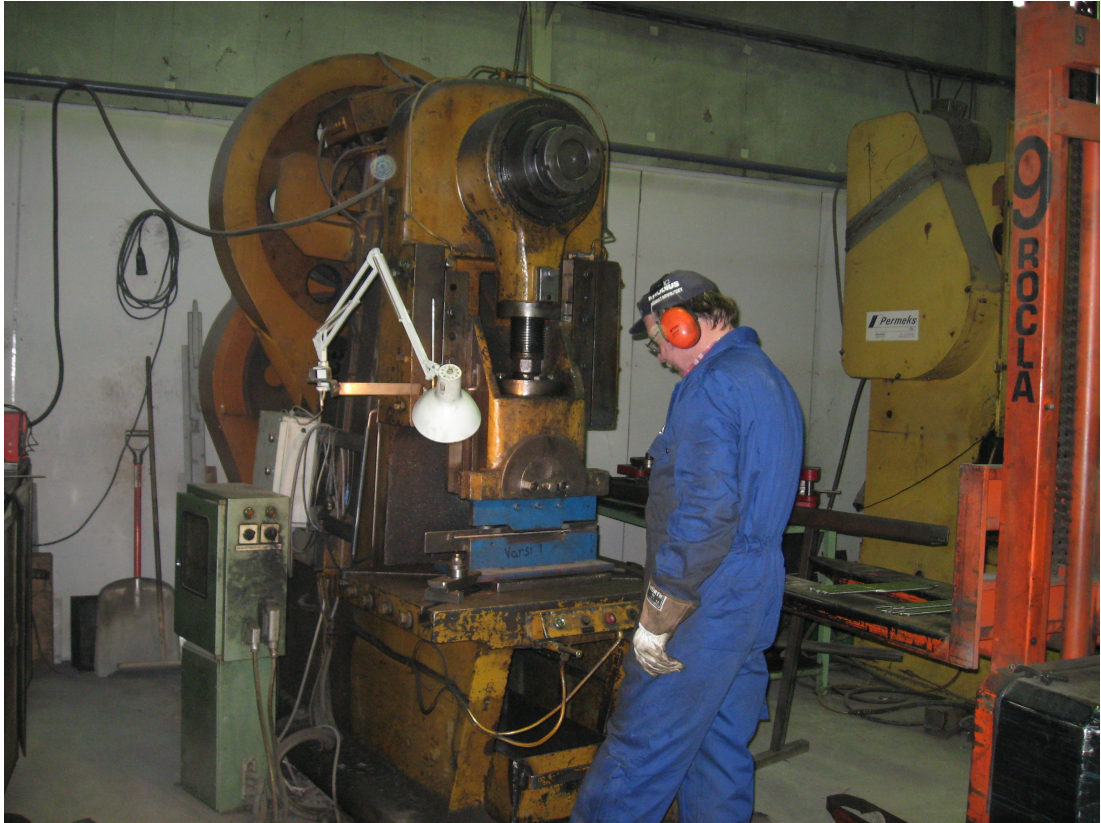
Kuva 2. Työskentelyä särmäyspuristimella osanvalmistuksessa.
