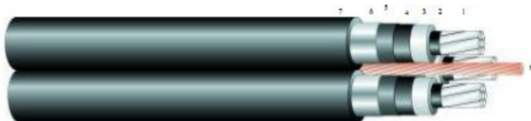
Kuva 3.1 AHXAMK – W 1. Johdin, 2. johdinsuoja, 3. eriste, 4. hohtosuoja, 5. vesitiivistysnauha, 6. kosketussuoja, 7. vaippa, 8. maadoitusköysi /3/
