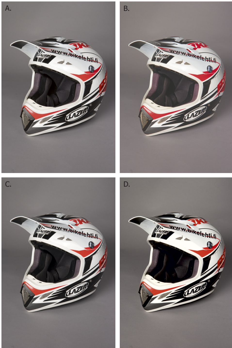
Kuva 27. Muunnosalgoritmien vaikutukset: A. Perceptual, B. Saturation, C. Relative Colorimetric, D. Absolute Colorimetric
