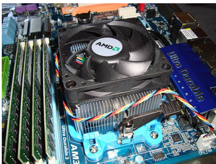
Kuva 4. AMD:n Boxed-jäähdytin kiinnitettynä kehikkoon. (WikiCommons 2010).
