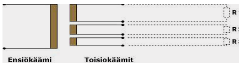
KUVA 23. Kaksikämmimuuntaja, jossa on yksi ensiökäämi ja useampi toisiokäämi (Intertrafo)
