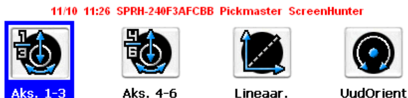
Kuva 20 Robotin liiketilamuodot joiden mukaan robotti liikkuu
