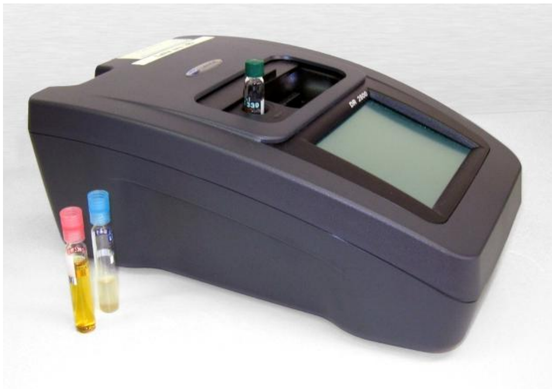
KUVA 2. Hach DR2800 –spektrofotometri (tekijän ottama kuva)
