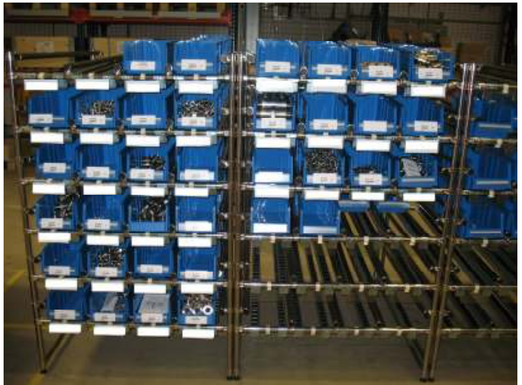
Kuva 18. Varaston uusi läpivirtaushylly
