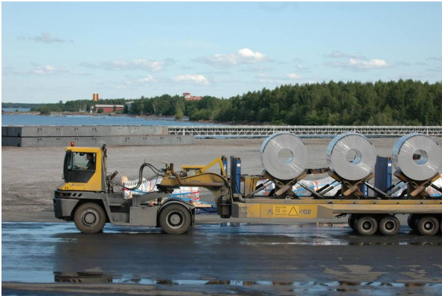
Kuva 6. Alamäen vetomestari sekä siirtovaunu. (Vaara 2010.)
