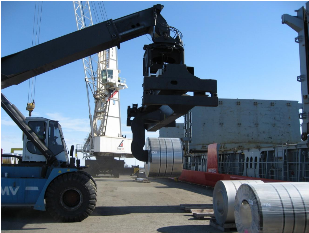
Kuva 7. Kurottaja nostaa rullaa C-koukulla. (Vaara 2010.)
