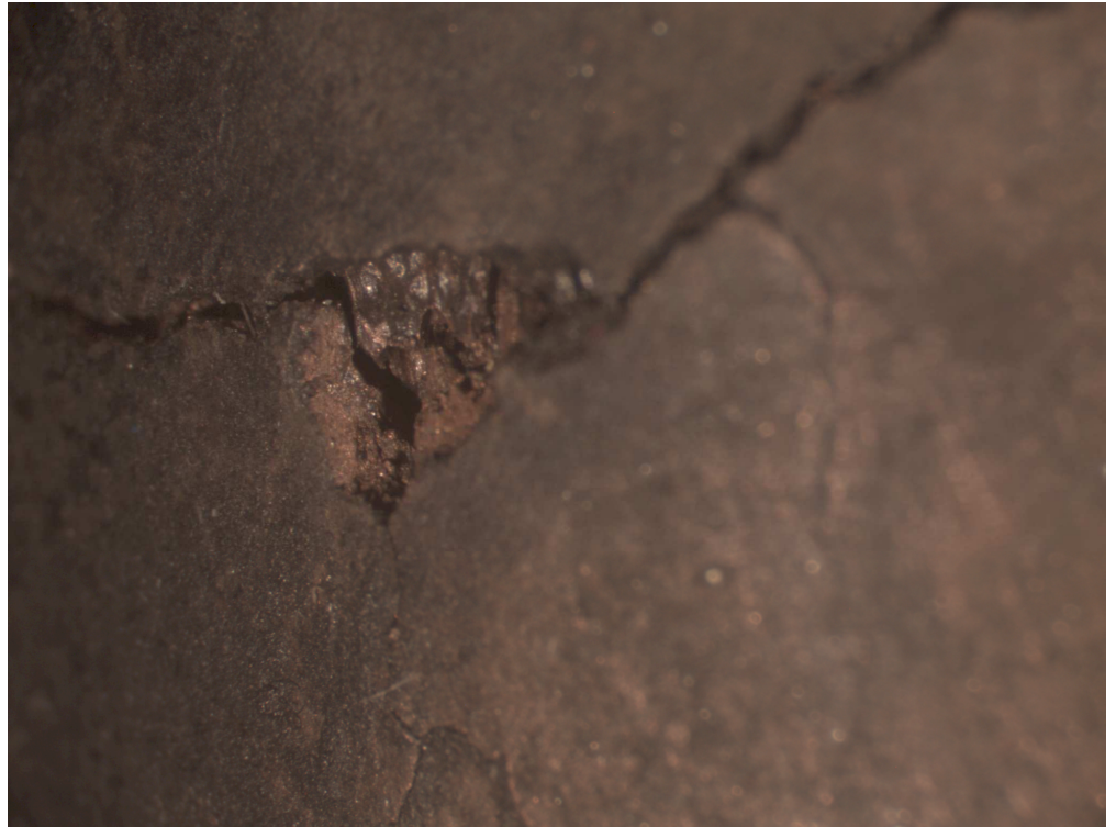
Kuva 3: Mikroskooppikuva vannasputken keskialueen halkeamasta
