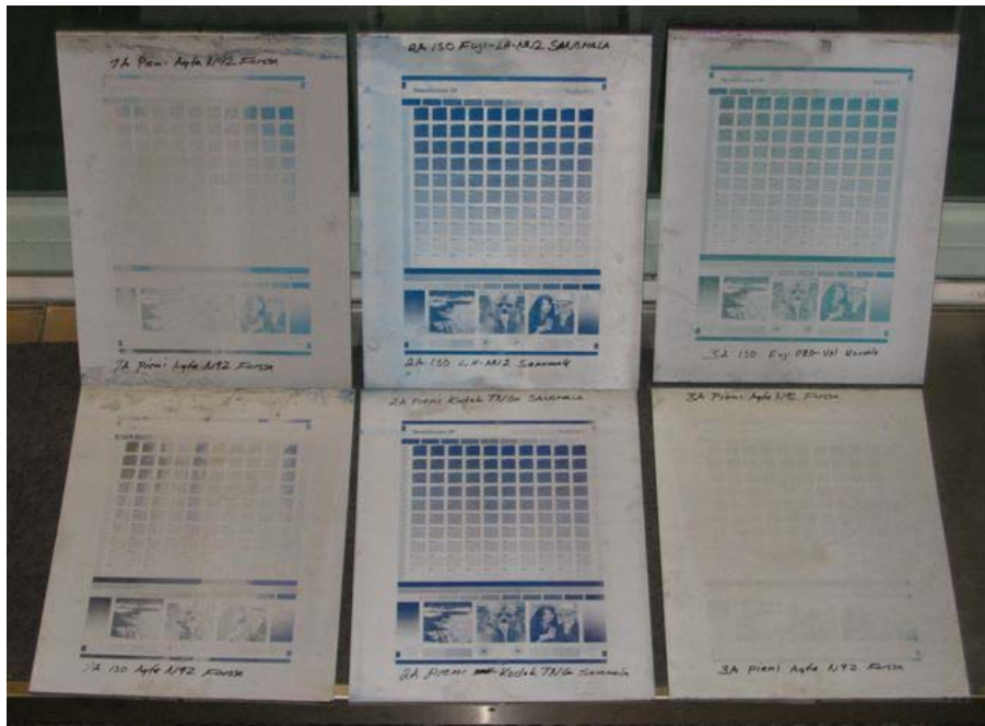
Kuva 28. Painolevyt painolaitteiden 1-3 A-vyöhykkeiden kohdalta
