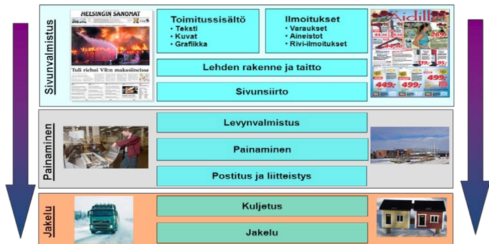
Kuvio 11. Sanomalehden valmistusprosessi (Sanomapainon esittely-kalvot. 2010)
