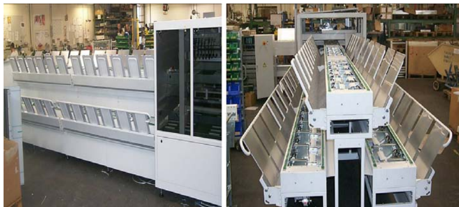
Kuva 23. Nela GmbH:n levyajittelija (Eckenwalder. 2010)
