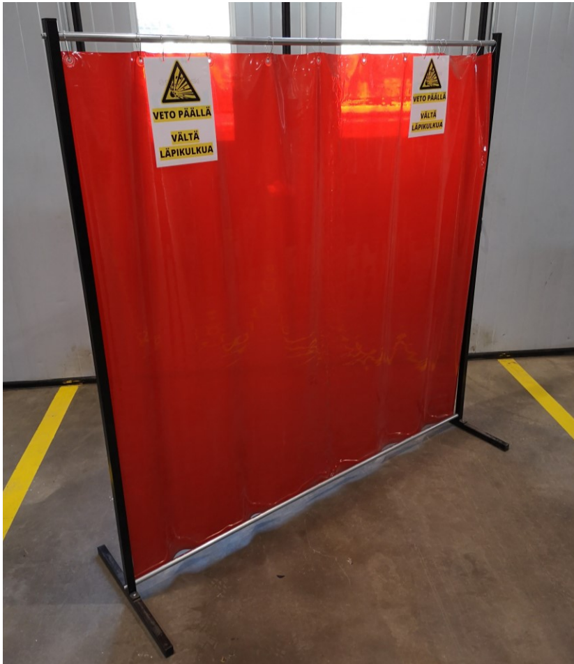
KUVA 11. Korinoikaisupenkin suojaverho ja varoituskyltti.
