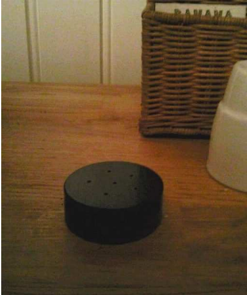
KUVA 10. Radonmittauspurkki. Huomioi mittauspurkin asettelu reikäpuoli ylöspäin. Purkin koko on tulitikkiuaskin luokkaa
