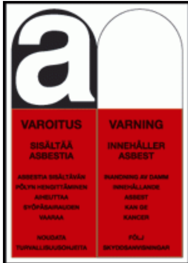
Kuva 1. Asbestia sisältävän kohteen varoitustarra (Ratu 82-0347 2009).
