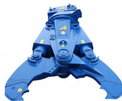
Kuva 4. Kaivinkoneeseen liitettävä leikkurimurskain kivirakenteita varten (Hansamachines, [Viitattu 15.8.2019]).
