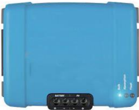
KUVA 13. Lataussäädin (mukaillen JN-Solar 2019a.)
