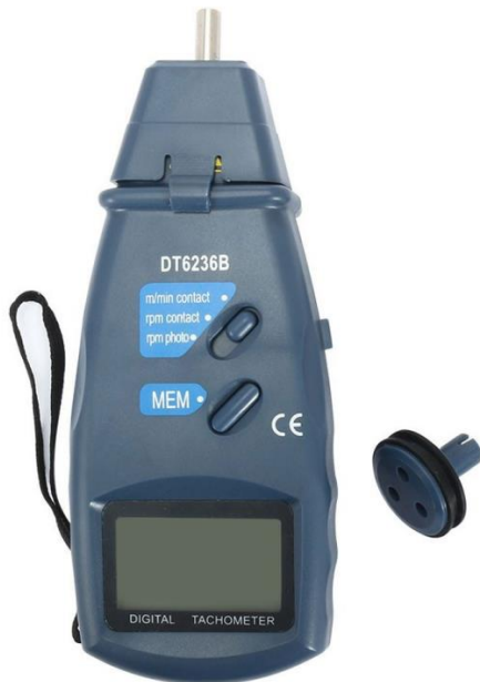
Kuva 7. Takometri ja mittaamisessa käytetty mittapää. CEM DT6236B Digital Tachometer.
