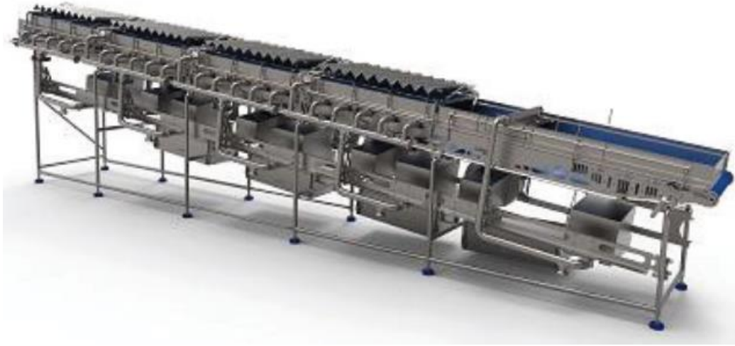
Kuva 32. Havainnekuva Eillertin tunnelikuivaimesta.
