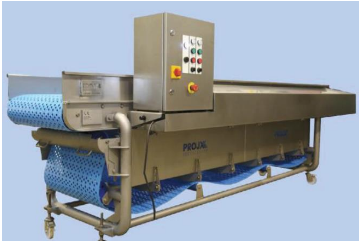
Kuva 31. Eillertin kuljetushihna. Hihnan rei'istä putoaa tärinällä irrotettu ylimääräinen pesuvesi.
