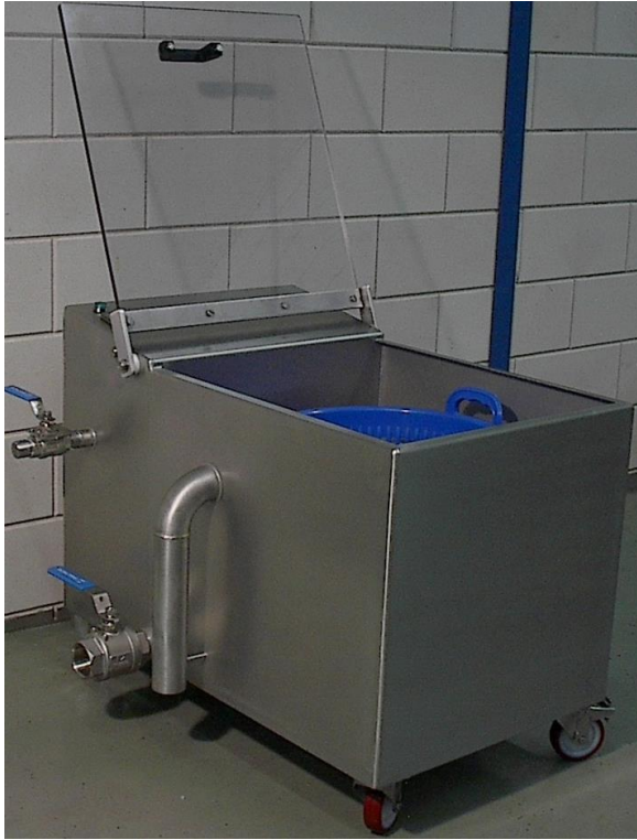
Kuva 5. Pesukone. Laite täytetään vedellä, pestävät tuotteet asetetaan pesukoriin koneeseen ja korin alta puhallettavalla ilmalla liikutetaan pestäviä kasviksia.
