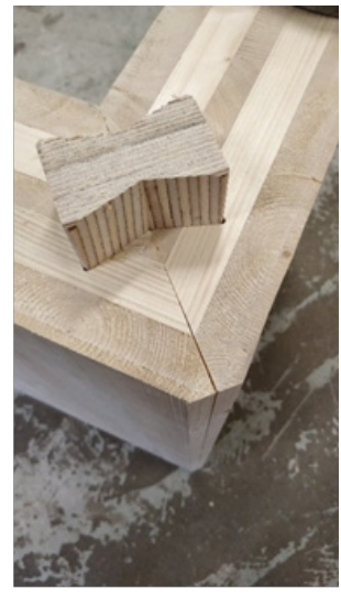
Kuva 4. Puinen kiilaliitos (Hyvärilä 2017)
