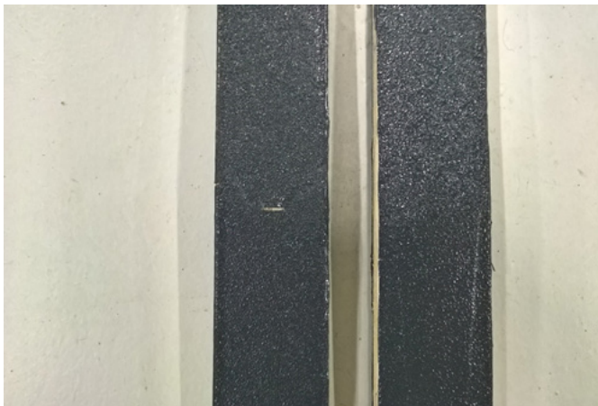
Kuva 44. Pinnoitteen rikkoutuminen alapinnalla suurella taipumalla (testikappaleet 6 ja 4) (Myllyniemi 2018)
