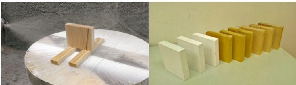
Kuva 21. Kartiokalorimetrikoe-kappaleiden pintakäsittelyä (Myllyniemi 2018)
