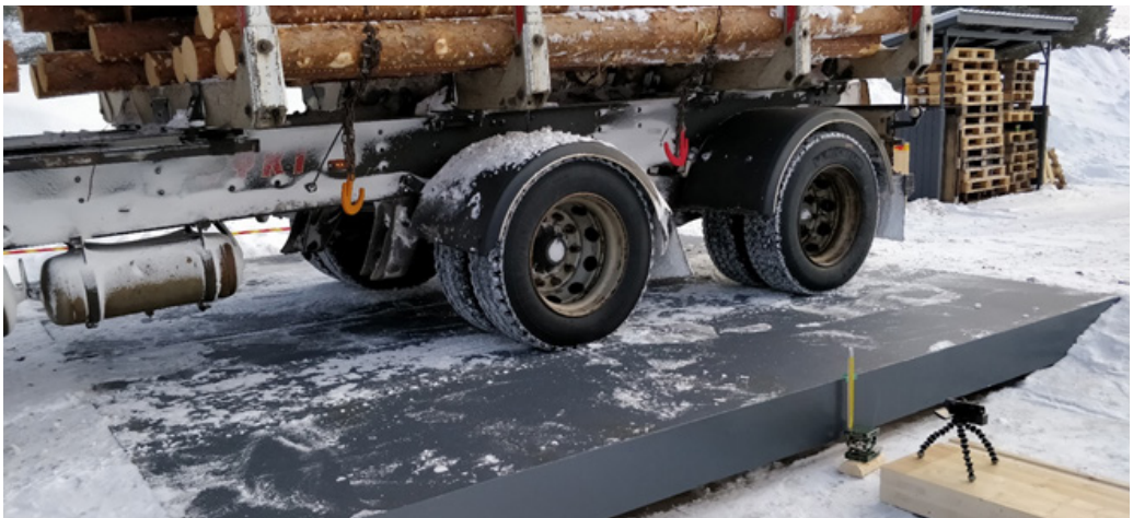
Kuva 54. Kuorma-auto sillan päällä suurimman taipuman hetkellä (Hyvärilä 2018)
