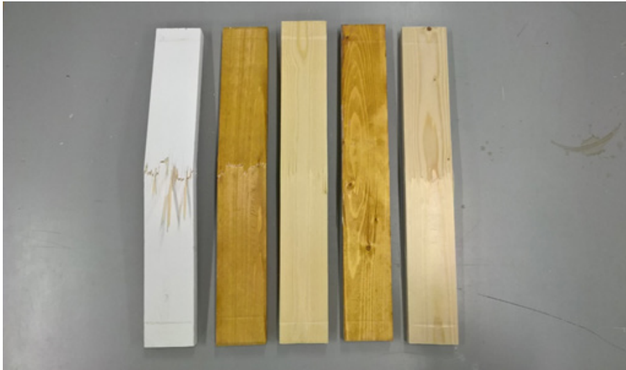
Kuva 17. Aineiden aiheuttamat värimuutokset. Vasemmalta oikealle: Teknosafe, HR Prof, NT Deco, MP FR Ultra ja käsittelemätön puu. (Myllyniemi 2018)
