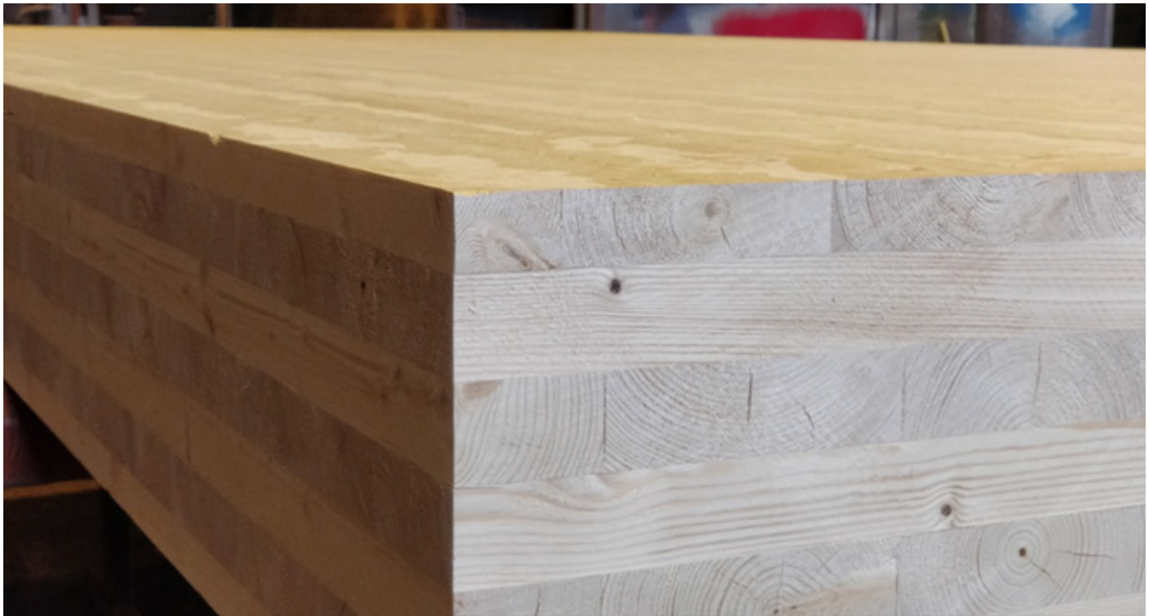
Kuva 34. CLT Finland Oy:ltä (Hoisko) tilattu CLT-elementti (levytyyppi H7) (Hyvärilä 2018)
