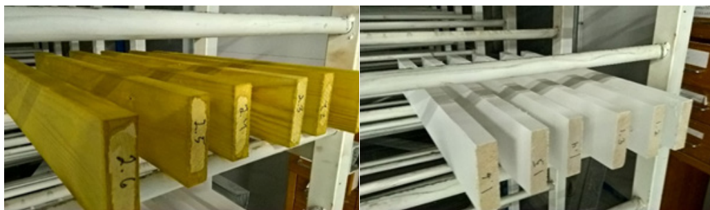
Kuva 19. Taivutustestikappaleita tasaantumassa pintakäsittelyn jälkeen (Myllyniemi 2018)
