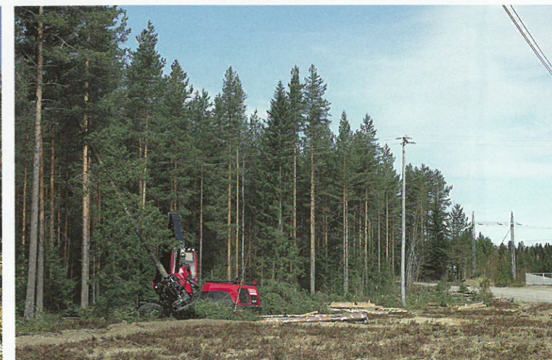
Leimikonsuunnittelun tekee usein vasta koneenkuljettaja työmaalle saapuessaan. On tärkeää, että kuljettaja tietää alueella olevasta suurjännitejohtosta ja osaa ottaa vaativat olot huomioon.
