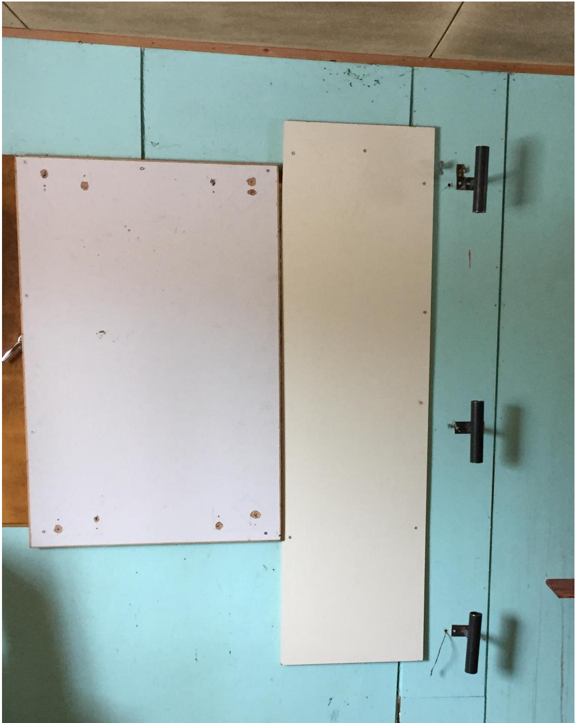
Kuva 2. Puupuolen anturoinnit ja suojat. Kuvassa vasemmalla levytetty rikkinäinen ikkuna. Termoparilankojen suojat kallistettiin kuvan oton jälkeen 45 asteen kulmaan.
