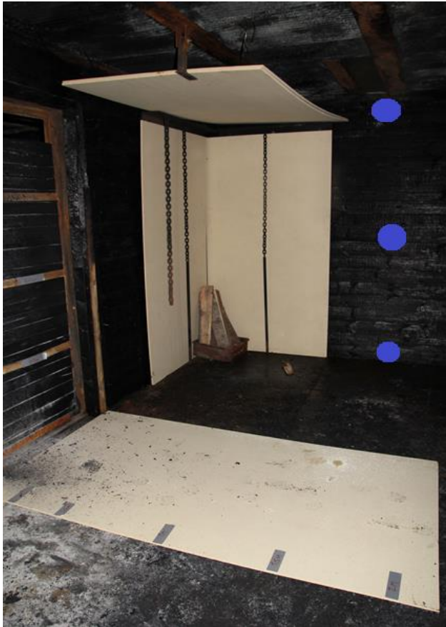
Kuva 13 Termoparilankojen sijoitus suhteessa alkupaloon
