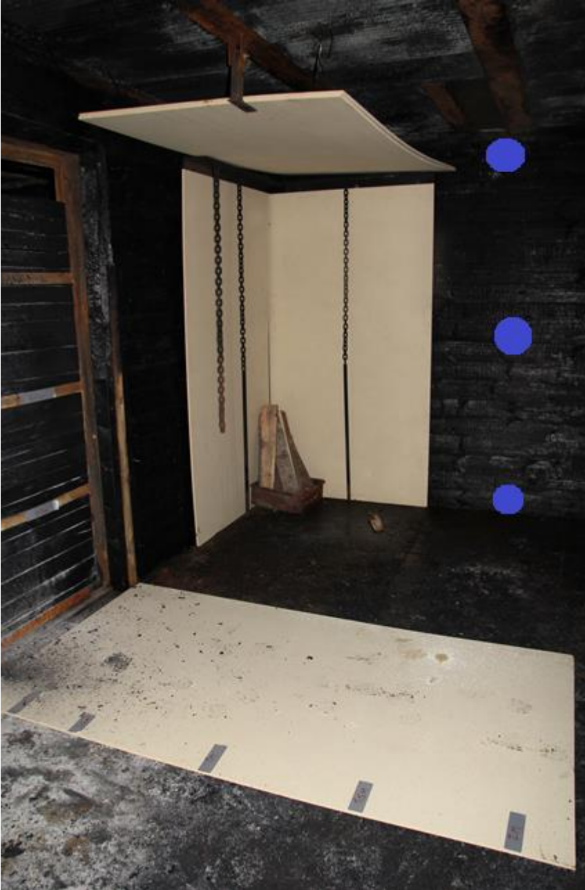
Kuva 1 DasyLab termoparilankojen sijainti hirsitalon kokeessa
