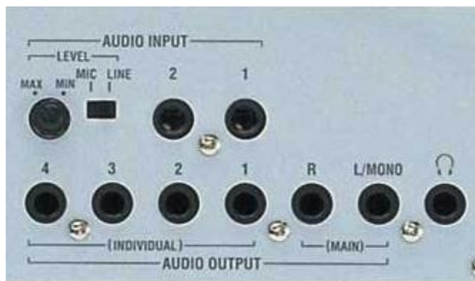
KUVA 9. Korg M3:n takapaneelistä löytyy yhteensä seitsemän analogista ulostuloa sekä kaksi analogista sisääntuloa. Liitännät ovat kooltaan 1/4"
