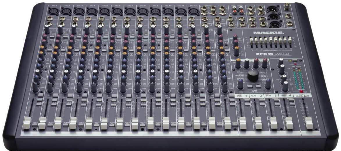
KUVA 5. Mackie CFX16 MK II on esimerkki tyypillisestä miksauspöydästä. (Centrum Muzyczne 2011.)
