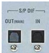
KUVA 10. Vasemmalla digitaalinen (optinen, S/P DIF) ulostulo ja oikealla digitaalinen sisääntulo
