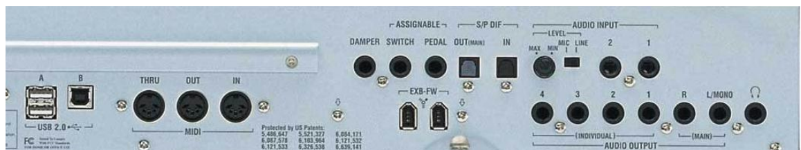
KUVA 6. Korg M3:n takapaneelissa on kattavat liitännät
