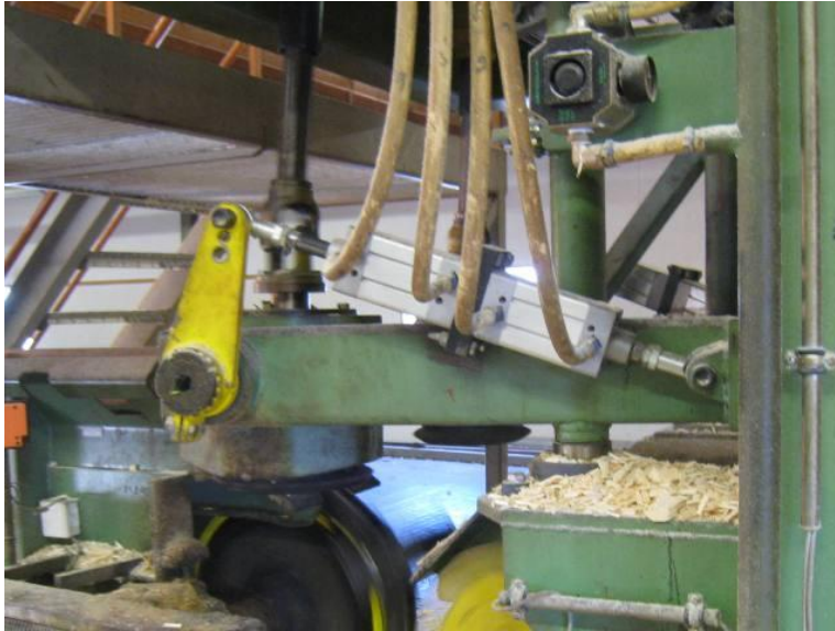
KUVIO 18. Tukinpyörittäjän kallistustelaa ohjaava pneumaattinen sylinteri
