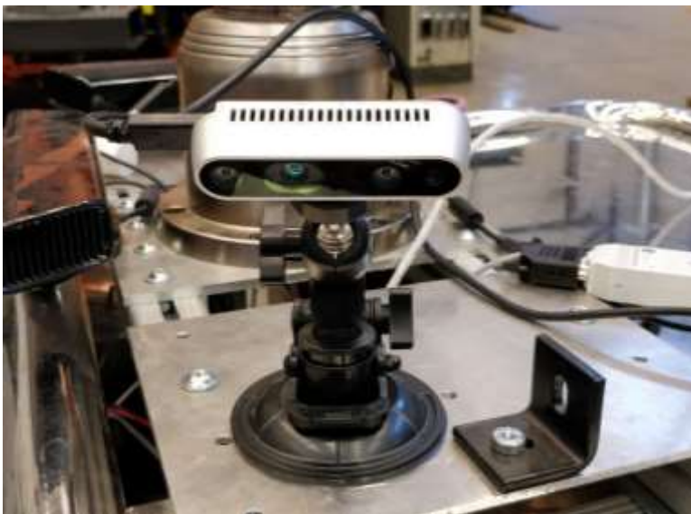
KUVA 8. Intel RealSense D435 3D-kamera kiinnitettynä mobiilirobottialustaan
