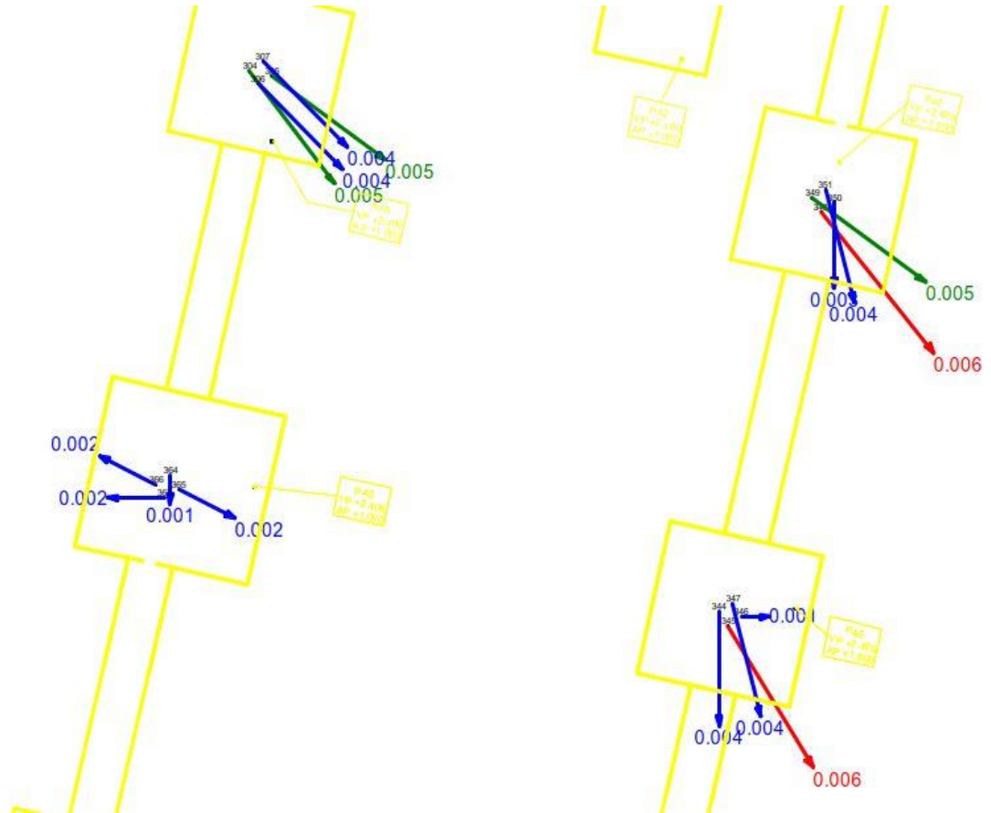
Kuva 12. 3D-Win-ohjelmalla tehty tarkekuva. Kuvan tarkoituksena on välittää katsojalleen mahdollisimman hyvä yleiskuva mitattujen kohteiden poikkeamista. 3D-Win-ohjelmalla tehdyssä tarkekuvasa nähdään peruspulttien tasosuuntaiset poikkeamat värikoodauksella. Tarkelaskennan toleranssiarvona on käytetty viittä (5) millimetriä. Toleranssin ylittävissä mitatuissa arvoissa nuolet näkyvät punaisena, toleranssin kanssa samat arvot näkyvät vihreinä ja toleranssin sisällä olevat sinisinä. Nuolen suunta osoittaa poikkeaman sijainnin suhteessa suunniteltuun arvoon.
