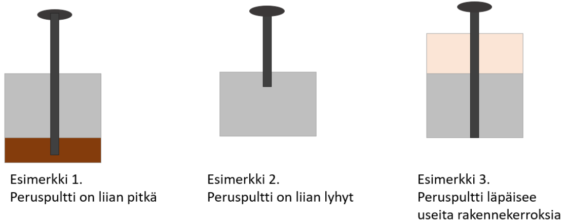
Kuva 7. Peruspulttien väärin pituuksien aiheuttamat ongelmat asennusvaiheessa.
