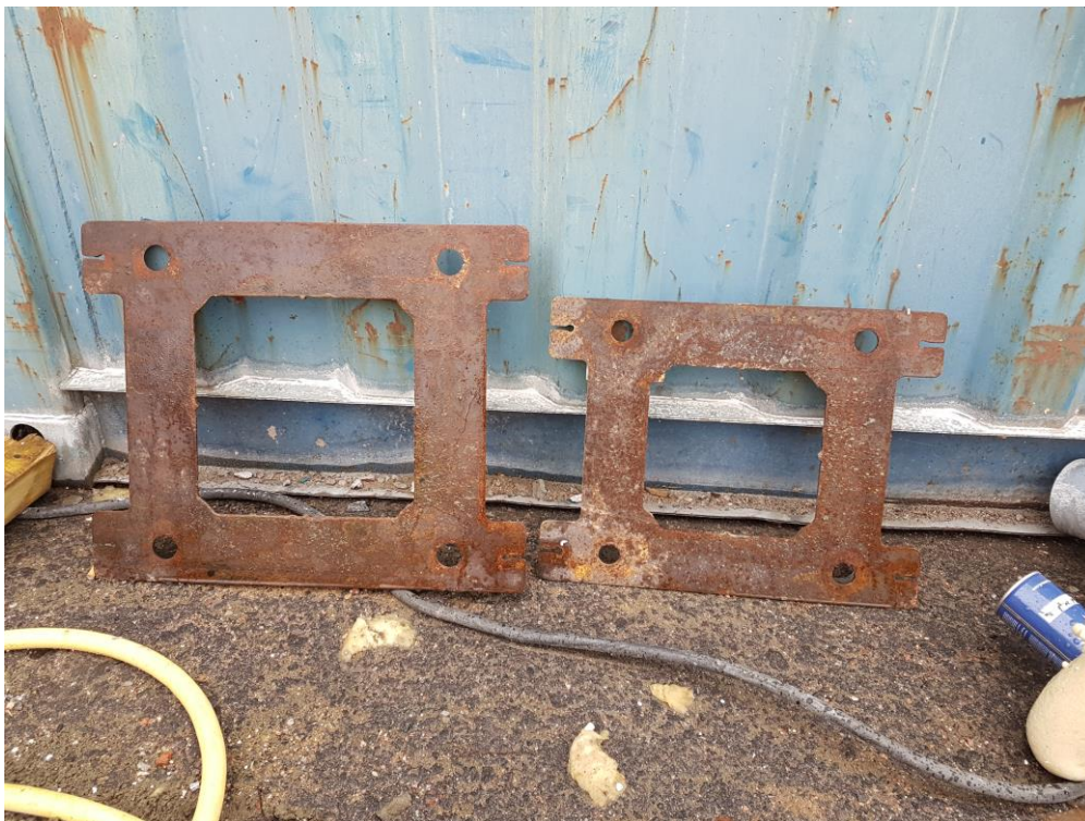
Kuva 9. Erikoisia terästoimittajan valmistamia asennussapluunoita.
